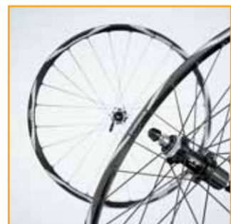
WH-M775 XT Laufradsatz, kompatibel mit Tubeless- und -Schlauchreifen. Center-Lock-Bremscheibenaufnahme.
